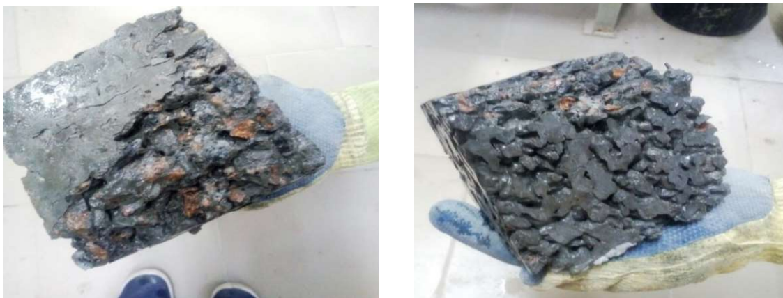
Рисунок 2 – Загальний вигляд зразку кубу проникуного цементобетону
